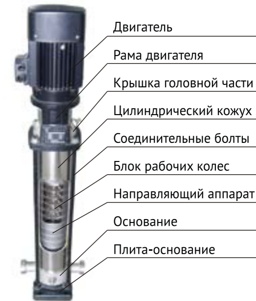
Рис.2. Конструкция насосов
