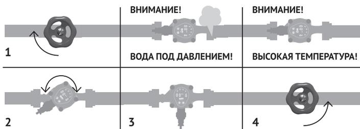
**Рисунок 3. Порядок изменения положения блока управления**
