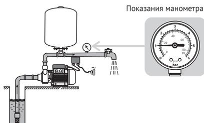
После окончания водоразбора, насос качает воду в гидроаккумулятор, расширяя мембрану и повышая давление в системе.
