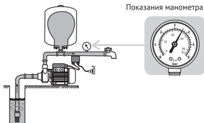
При начале водоразбора, вода, находящаяся в мембране гидроаккумулятора под давлением, начинает подаваться потребителю. При этом давление в системе начинает уменьшаться, а насос остается выключенным.
