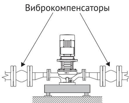
Рисунок 10. Насос TD с виброкомпенсаторами большего диаметра.
