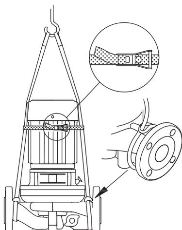
Рисунок 2. Перемещение насосов, не имеющих специальных креплений.
