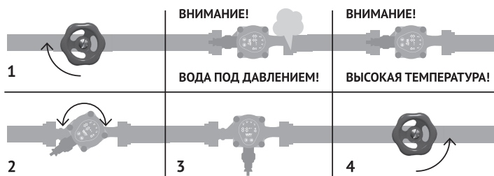
Рисунок 3. Порядок изменения положения блока управления
