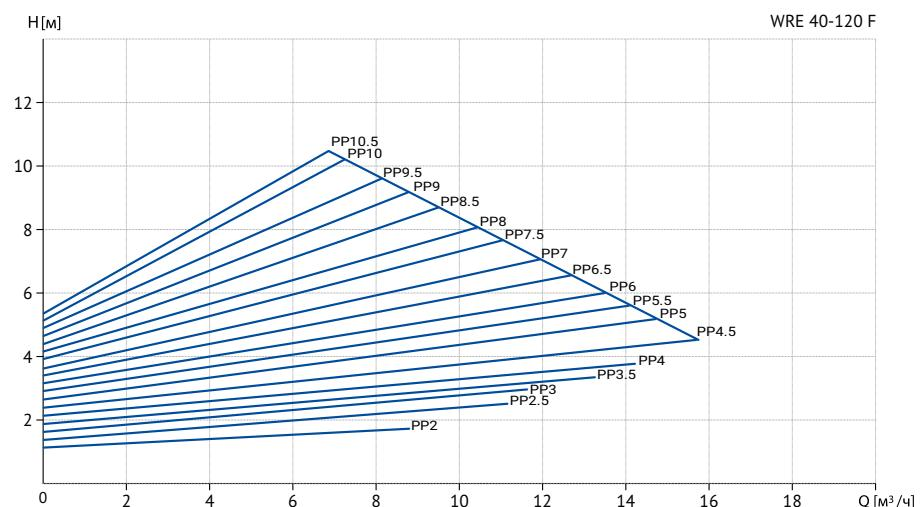
Режимы: СР - постоянное давление, СС - Постоянная скорость, РР - пропорциональное давление
