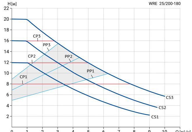
Режимы: СР - постоянное давление, CS - Постоянная скорость, PP - пропорциональное давление
