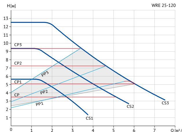
Режимы: СР - постоянное давление, CS - Постоянная скорость, PP - пропорциональное давление
