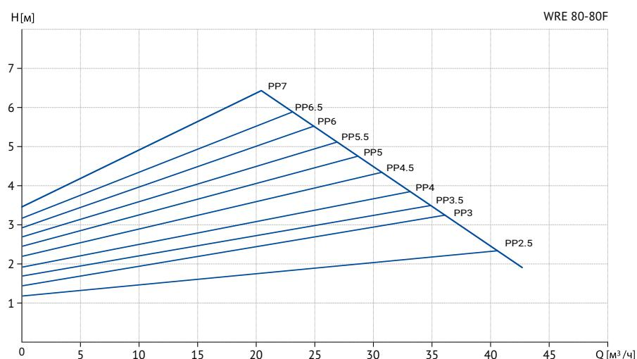
Режимы: СР - постоянное давление, CS - Постоянная скорость, PP - пропорциональное давление
