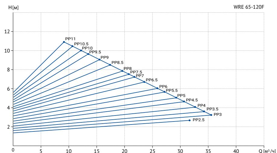
Режимы: СР - постоянное давление, CS - Постоянная скорость, PP - пропорциональное давление
