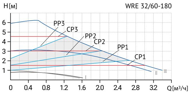
Режимы: CP - постоянное давление, CS - Постоянная скорость, PP - пропорциональное давление
