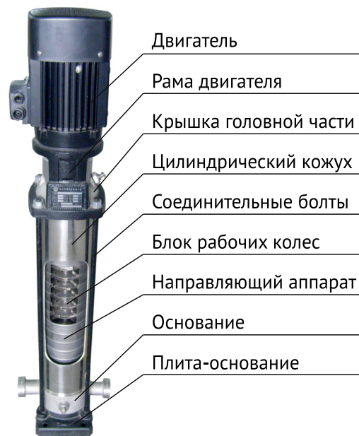
Рис.2. Конструкция насосов
