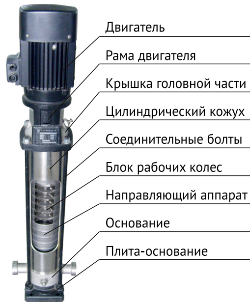
Рис.2. Конструкция насосов
