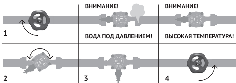
Рисунок 4. Порядок изменения положения блока управления
