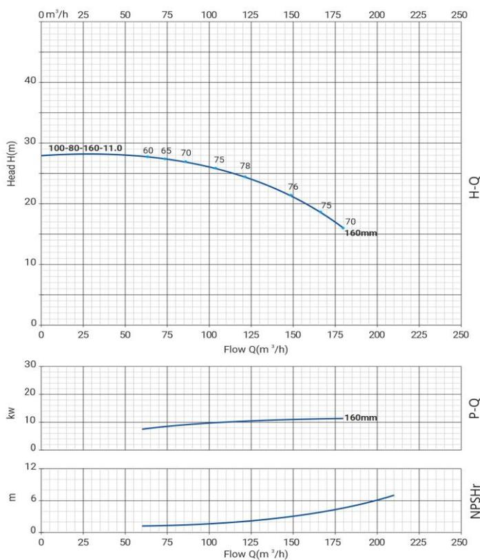
Параметры насоса рассчитаны для чистой воды плотностью 998,2 кг/м³, температурой 20 °С, вязкостью 1 мм²/с
