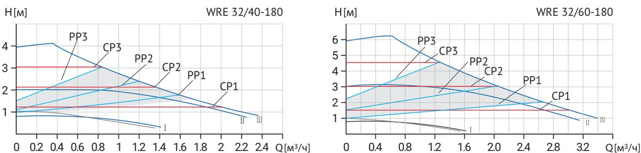
Режимы: CP - постоянное давление, CS - Постоянная скорость, PP - пропорциональное давление
