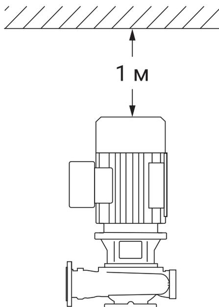
**Рисунок.4. вертикальное расположение насоса**
