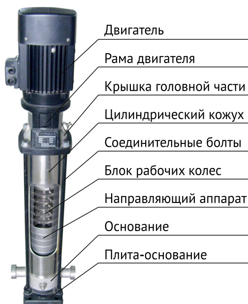
Рис.2. Конструкция насосов
